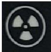
Luz indicadora de exposición: Cuando se enciende la luz, indica que el sistema de TC está emitiendo rayos X. Cuando la luz está encendida, el zumbador del interior de la caja de TC emite un sonido de alarma. Cuando la luz se encuentra apagada, indica que el sistema de TC no está emitiendo rayos X.
