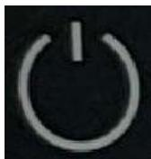
Luz indicadora de inicio de sistema: Cuando el sistema esté alimentado y encendido, se enciende la luz indicadora. Cuando se apaga el sistema, la luz indicadora se apaga también.
